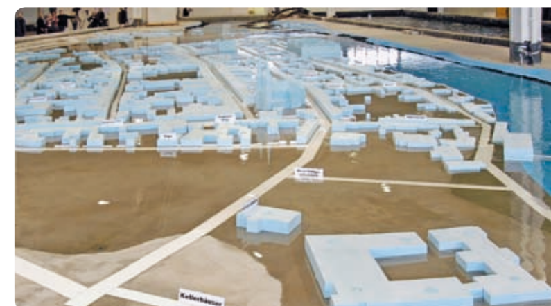
Physikalisches Modell Maßstab 1:50 der Vereinigten Mulde und der Innenstadt von Grimma
